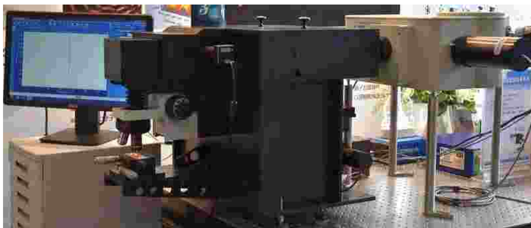
图1: 无需关闭实验室灯光照明, 在日常光照条件(类似于展厅)下就可以进行常规光路调试、RTD预测试调节以及高信噪比的拉曼光谱测试
